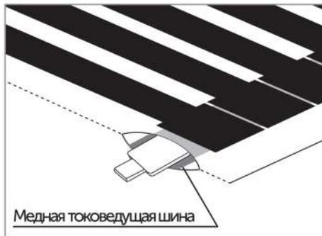
Установите на медную токопроводящую шину **зажим**. Одну половинку зажима с зубцами вставляют внутрь пленки, вторую – снаружи поверх медной шины. При помощи пассатижей или специального
