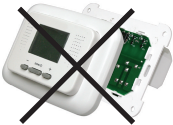
Рис. 9а Неправильное снятие крышки прибора
