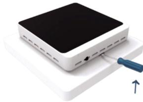
Вставьте небольшую плоскую отвертку в специальное отверстие внизу экрана и осторожно надавите, ослабляя крепление. Отделите экран от корпуса.
