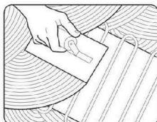
Используя плоский шпатель, покройте нагревательный мат слоем плиточного клея толщиной 8 - 10 мм или слоем самовыравнивающегося бетона толщиной 15 мм, не допуская образования пузьрей и поднятия нагревательного мата. При нанесении и отвердевании плиточного клея температура основания и окружающего воздуха должна быть от +5 °C до +25 °C, а так же в помещении не должно быть сквозняков.
