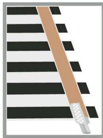
Образец "клипсования", два зажима крепятся к медному проводнику (зажим заводится между двумя слоями пленки в специальный "кармашек") и заклеивается с двух сторон отрезками изоляционной ленты.
