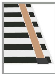
Образец изолирования окончания отреза плёночного тёплого пола.
